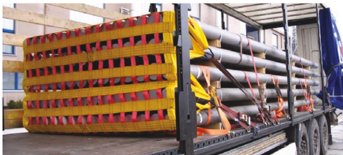
Rysunek 32: Zabezpieczenie za pomocą sieci i mocowania za pomocą odciągów prostych dociskających ładunek w kierunku jazdy
