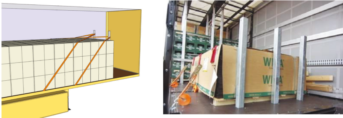
Rysunek 7: Kłonice zastosowane w celu mocowania blokowego zabezpieczającego ładunek przed przemieszczeniem do przodu
