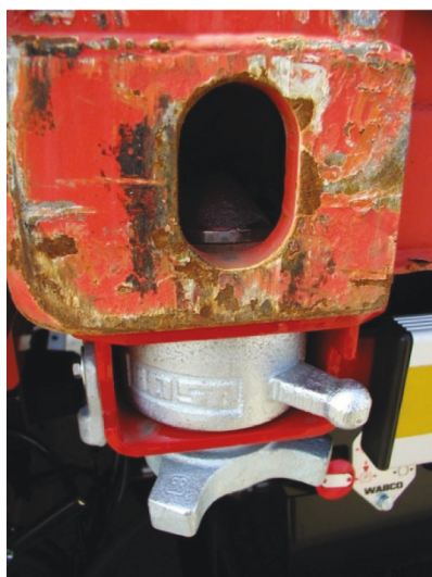
Rysunek 17: Łącznik skrętny z kontenerem
