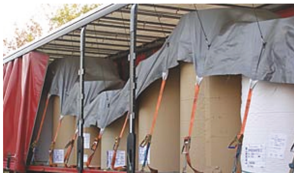
Rysunek 31: Mocowanie za pomocą opończy
