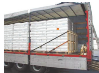
Rysunek 39: Mocowanie szpringowe za pomocą palet
