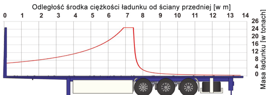
Rysunek 5: Schemat obciążeń naczepy o 3 osiach
