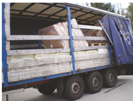
Rysunek 19: niedostateczne zabezpieczenie ładunku za pomocą samej folii wstępnie rozciągniętej
