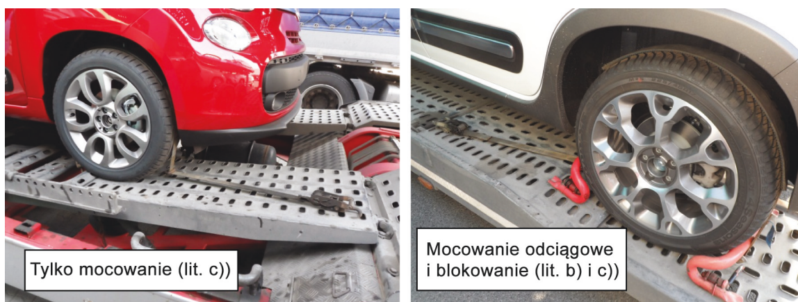
Rysunek 57: System mocowania w przypadku przewozu pojazdów
