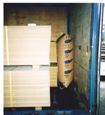
Rysunek 29: Poduszka powietrzna do unieruchamiania bocznego
