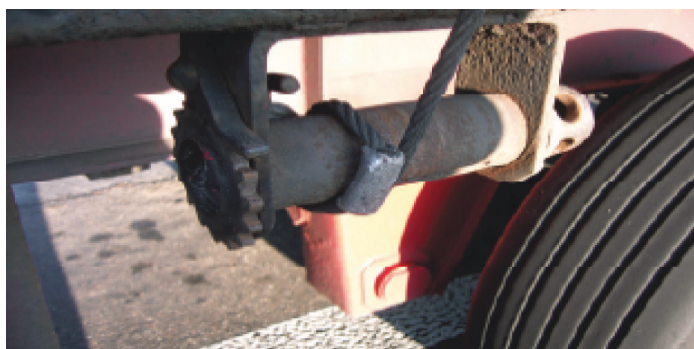
Rysunek 24: Stalowa lina naprężana za pomocą wciągarki
