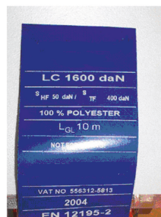
Rysunek 21: Etykieta odciągu taśmowego
