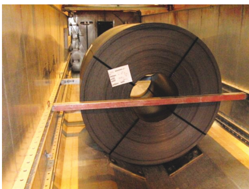
Rysunek 61: Przewóz kręgu specjalistycznym pojazdem
