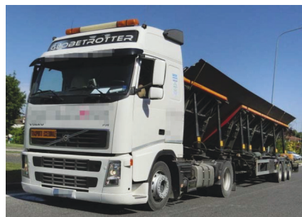
Rysunek 14: Płyty stalowe przewożone pod kątem 45°
