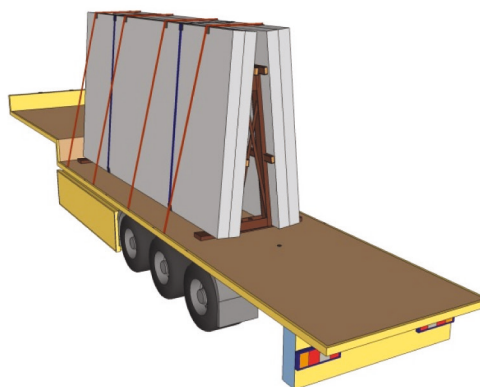
Rysunek 48: Mocowanie za pomocą połączenia blokującego, A-kształtnego stojaka, odciągów przepasujących ładunek i przepasania od góry.
