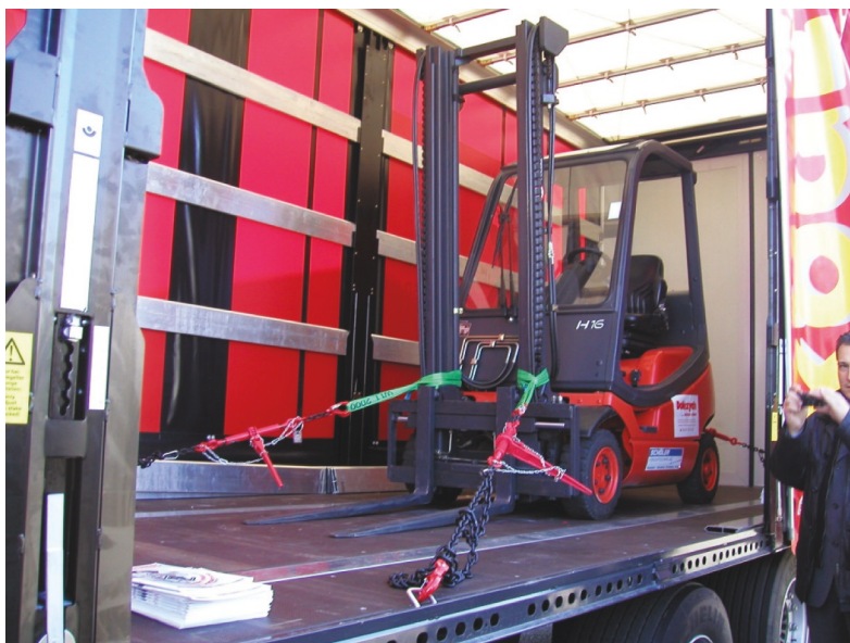
Rysunek 36: Mocowanie za pomocą odcągów prostych
