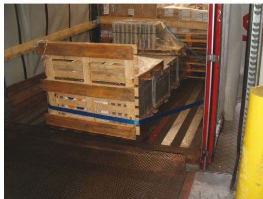
Rysunek 75: System mocowania ładunku mieszane do tyłu
