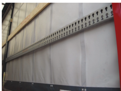
Rysunek 27: Listwy aluminiowe z otworami na belki blokujące
