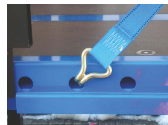
Rysunek 13: Otwór kotwiący w profilu bocznym
